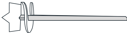
Рис. 2.7.4. Сверло для устройства трубных разводов в стенах
